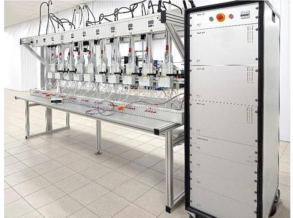
Каждая поверочная установка позволяет поверять до 20 электросчетчиков одновременно в автоматическом режиме, с возможностью распечатки протокола поверки.
